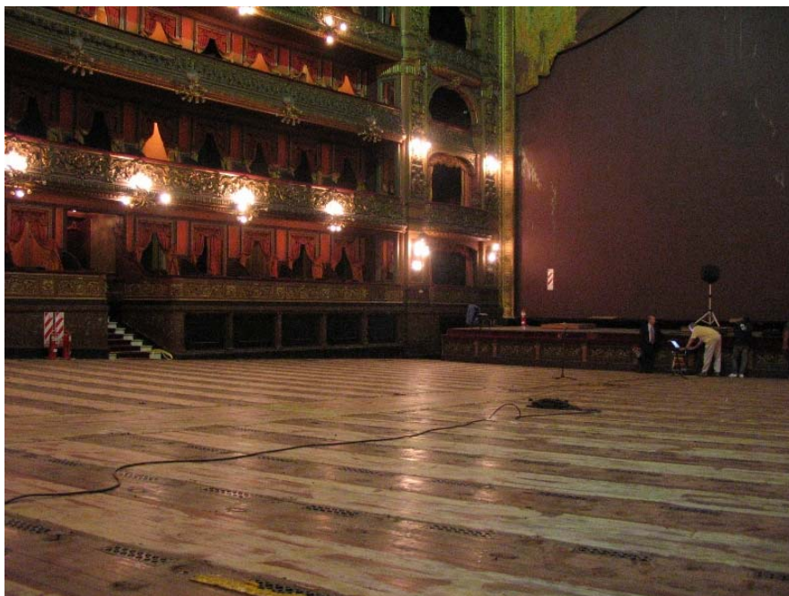
Figura 5. Medición luego del retiro de las alfombras de platea
