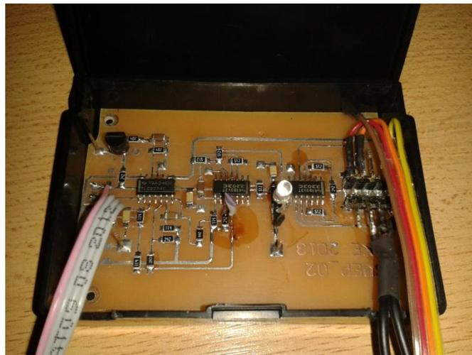
Figura 5.17. Amplificador de EEG implementado.
