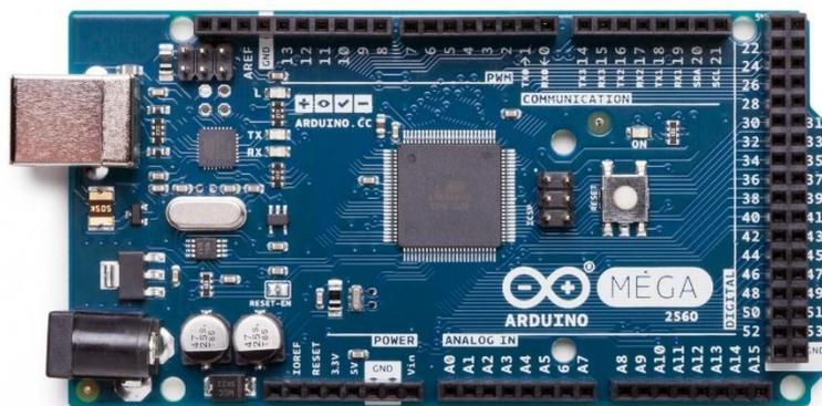
Figura 2.7. Arduino Mega2560.
