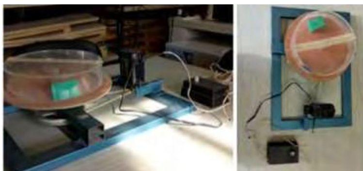
Dispositivo empleado para analizar la interacción de una partícula con una pared lateral Figura 4
