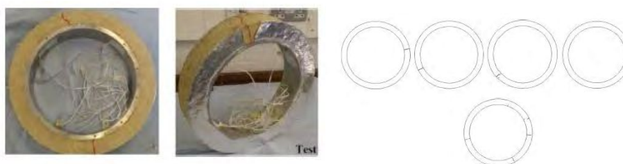
Figura 5. Patrones de fisuración anillos circulares. Ensayos [3] (izq.) - Modelo (der.)
