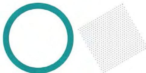
Figura 2. Malla de elementos finitos convencional (izq.), malla de material (der.)
