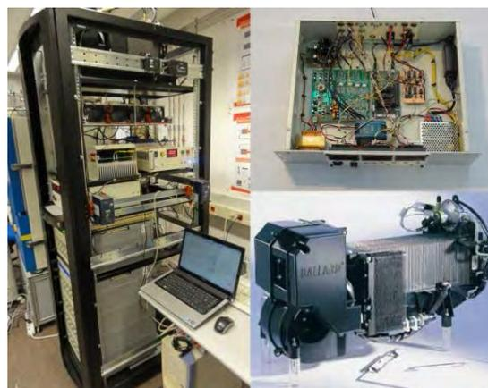
Figura 2. Sistema híbrido de energía basado en PCs. Colaboración con el IRI (CSIC-UPC), Barcelona, España.
