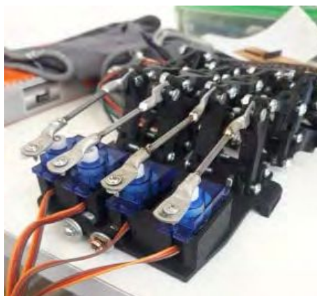
Figura 4. Disposición de los servomotores para formar el conjunto de actuación
