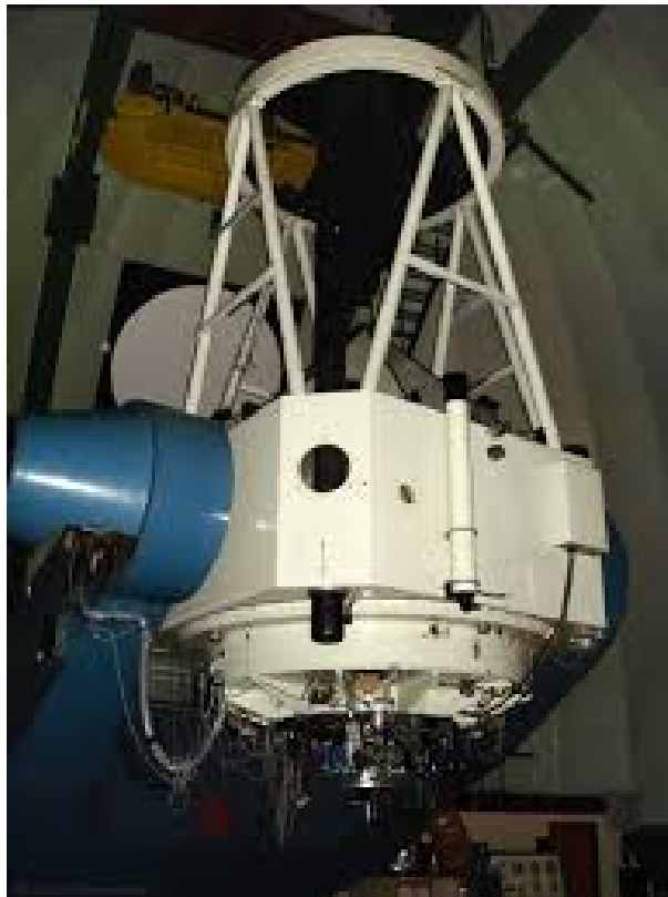
Figura 3.2: Telescopio de 2.15 m, en el que está montado el polarímetro CasPol (San Juan, Argentina).
