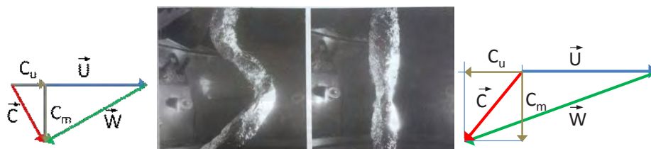
Figura 6. Diferencias de comportamiento de la antorcha de cavitación de acuerdo a la magnitud y dirección del momento cinético a la salida del rodete
