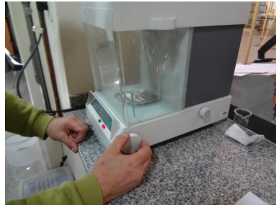
Fig. 11. Pesada de una muestra de material extraído para determinación de la NSDD
