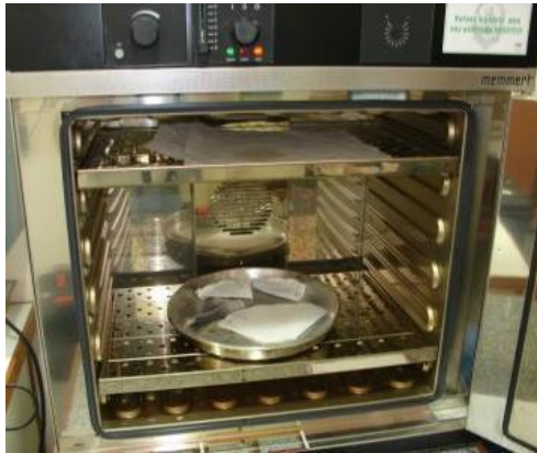
Fig. 10. Secado del material extraído para la determinación de la NSDD
