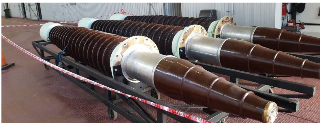
Figura 2.13 - Bushings de 330kV.
