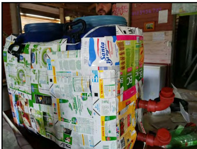
Figura 1.- Tanque de almacenamiento del calentador solar
