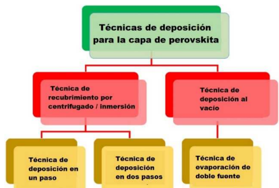
Figura 3 - Distintas formas de deposición para fabricación de PSC [4].
