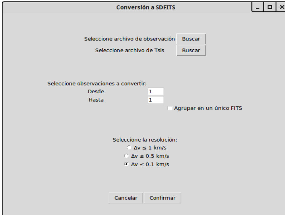
Figura A.2. Ventana de configuración para la conversión de datos en formato Delta-DOR al formato SDFITS. Esta interfaz permite buscar el archivo de sesión de observación necesario para la conversión. Una vez seleccionado el archivo, el usuario deberá elegir qué observaciones serán convertidas (por defecto, todas las correspondientes a la sesión de observación seleccionada, sin agrupar). Además podrá elegir la resolución del espectro de salida entre tres opciones (1 km/s, 0.5 km/s ó 0.1 km/s).
