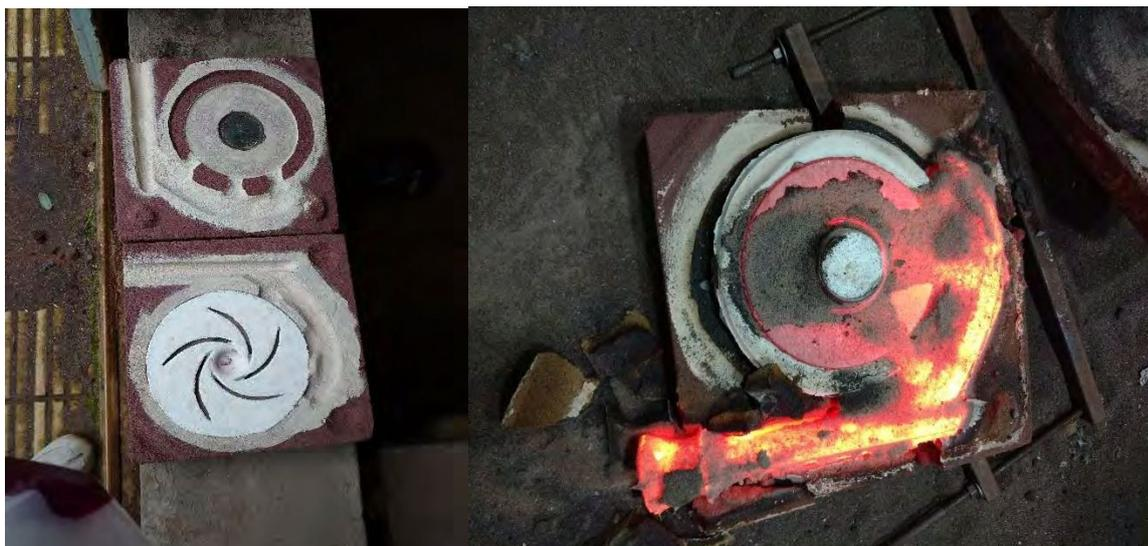
Figura 3 izquierda molde con noyo cerámico, derecha pieza de ACI CA40 obtenida con noyo cerámico.
