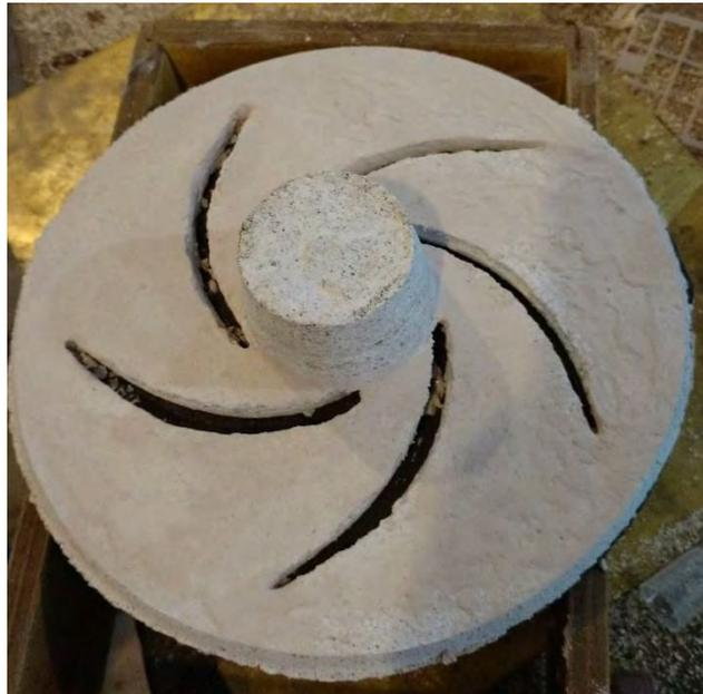
Figura 2 noyo sinterizado
