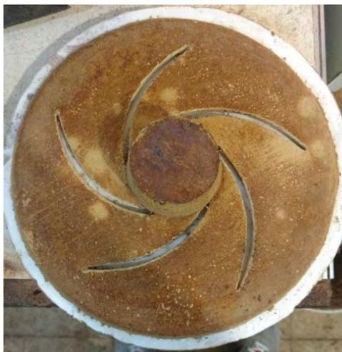
Figura 1 noyo sin sinterizar de cuarzo malla 200 fabricado con relación agua resina 90 10
