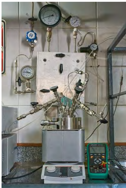
FIGURA III-13. REACTOR A PRESIÓN BERGHOF MODELO Y ESQUEMA DEL MISMO.
