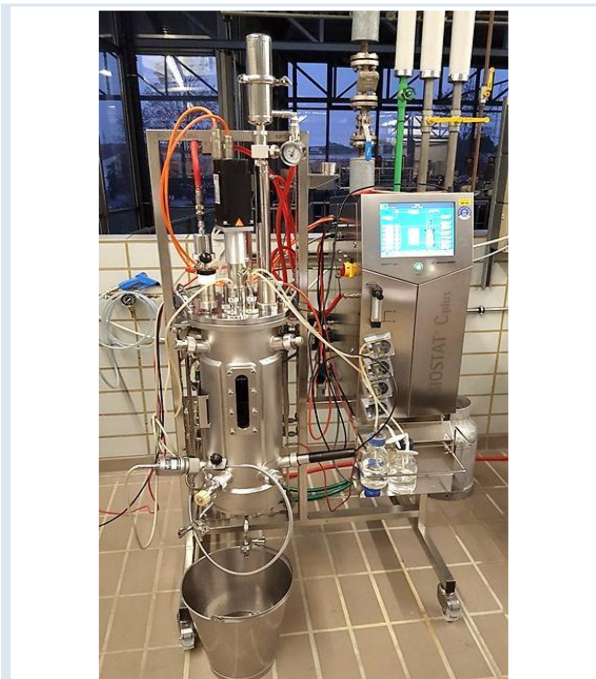
Figura 3.1. Fermentador de acero inoxidable Biostat C Plus (Startorius, Alemania) de 15 L de capacidad, control automático de pH, agitación y temperatura.
