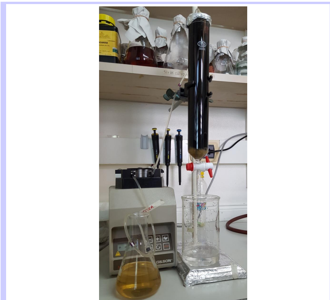
Figura 2.2. Equipo para la purificación de FOS. Las mezclas de síntesis (Matraz de Erlenmeyer) fueron cargadas mediante recirculación con una bomba peristáltica en una columna de vidrio con carbono activado como adsorbente. La elución de los azúcares se realizó lavando la columna con soluciones de concentración creciente de etanol en agua.
