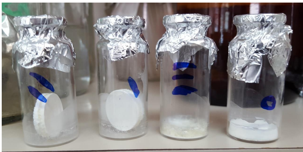
Figura 2.4. Fotografía de los viales conteniendo Lactobacillus delbrueckii subsp. bulgaricus CIDCA 333 liofilizado en presencia de soluciones 20 % p/v de los azúcares estudiados, se obtuvieron sólidos amorfos.
