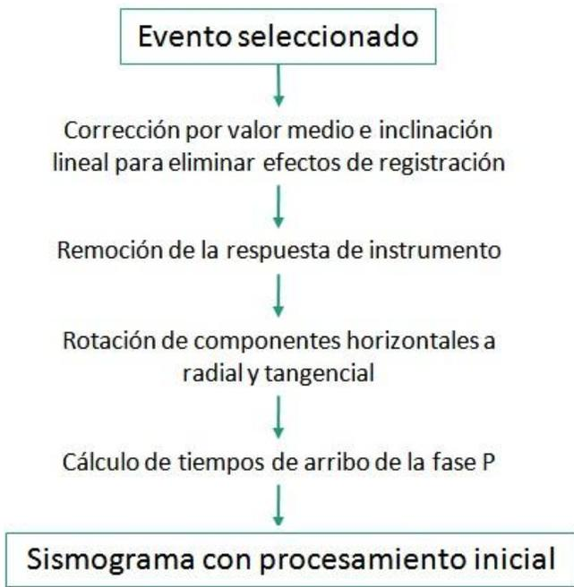
Figura 2.12: Diagrama de flujo indicando el procesamiento inicial para cada terremoto seleccionado.
