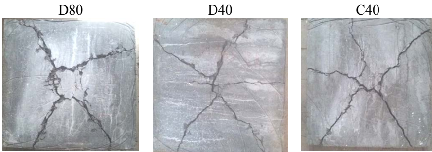
Figura 6. Fotografías de la cara traccionada de las losas.
