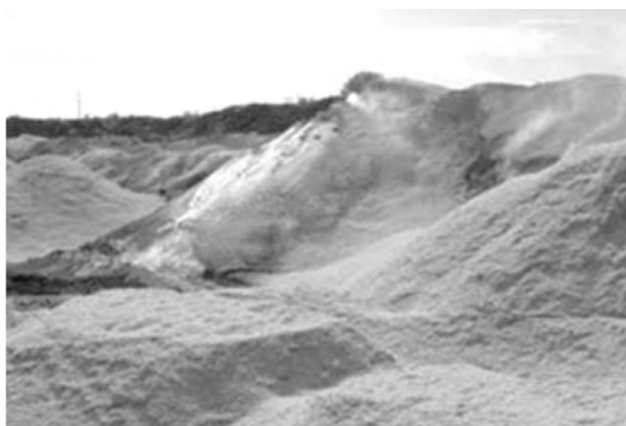
Figura 1. Acopios de cáscara de arroz y de la ceniza en estado natural durante el proceso de homogenización para el estudio experimental.
