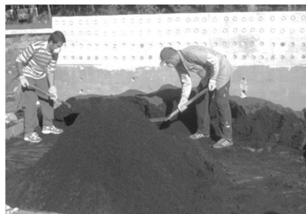
Figura 1. Acopios de cáscara de arroz y de la ceniza en estado natural durante el proceso de homogenización para el estudio experimental.
