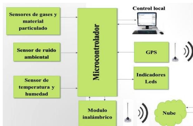
Figura N°1. Diagrama en bloques del sistema.
