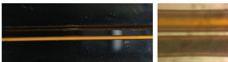
Figura 3.5. Fotografías de un capilar vacío (arriba) y relleno con un monolito de poli(GMA-co-EDMA) (abajo), sin aumento (izquierda) y con aumento de 60x (derecha).
