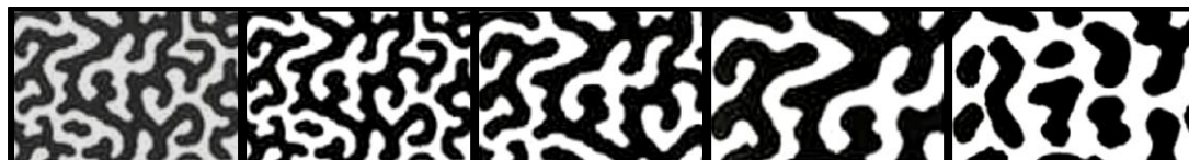
Figura 2.4. Esquema de separación de fases por descomposición espinodal[6].
