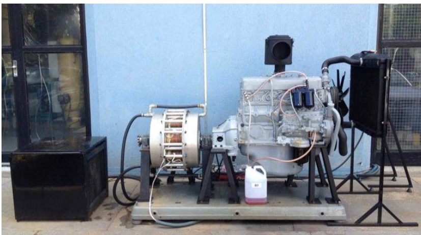
Figura 1. Bancada dinamométrica montada para os testes.
