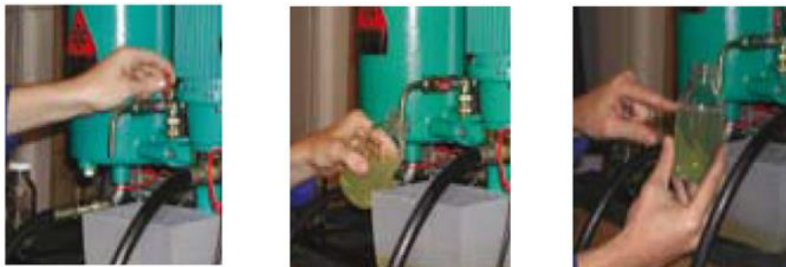
Figura 3. Esquema de extracción por válvula de toma de muestras.
