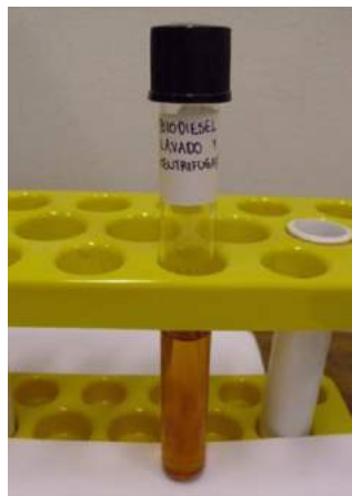
Figura 4. Biodiesel Lavado y centrifugado.
