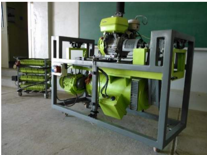
Figura 5. Disposición del motor instalado en el banco de pruebas.
