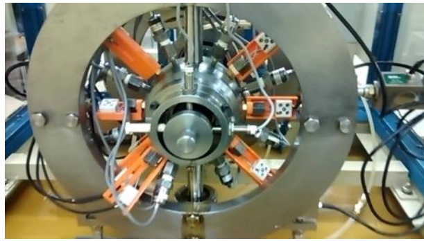
Figura 4. Equipo en funcionamiento. Se aprecia cómo el excedente de aceite escurre por los extremos del cojinete.
