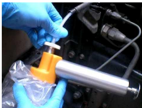
Figura 5. Botella con bolsa "ziplock" montada en la bomba de vacío manual.
