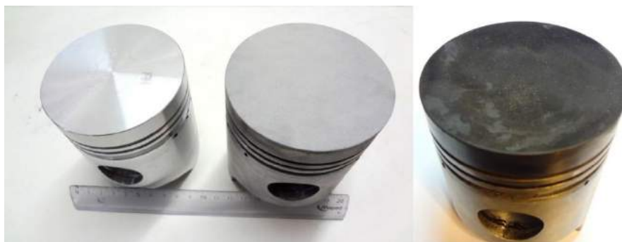
Figura 8. Estado del recubrimiento luego de 60 horas comparado con el estado inicial. No se observan desprendimientos.
