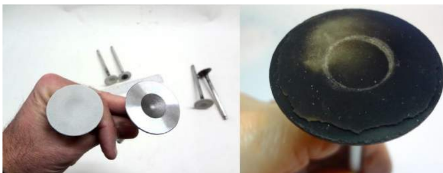
Figura 7. Válvulas nuevas con y sin recubrimiento sin uso y luego de 60 horas de funcionamiento.
