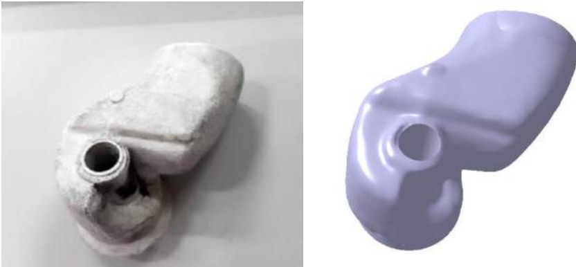
Figura 4. Molde de silicona y digitalización del canal de admisión de la tapa de cilindros.
