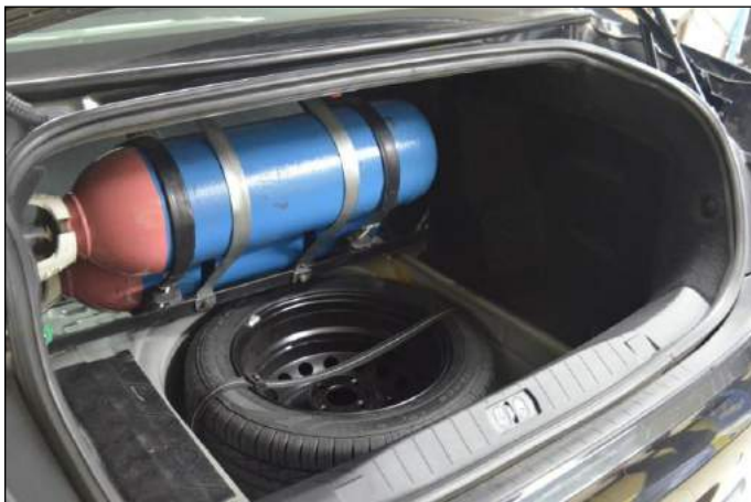
Figura 8. Vista de la instalación de los tubos con mezcla \text{CH}_4+\text{H}_2 (20%).
