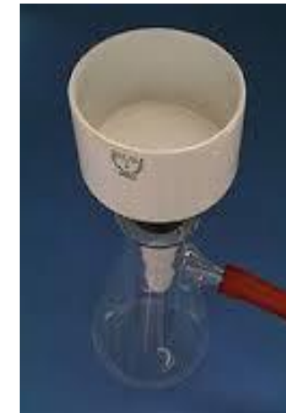
Lavado por Filtración
