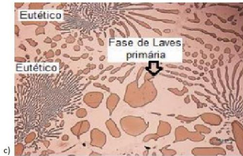
Figura 1. Microestrutura das ligas: c) Tribaloy T-400.
