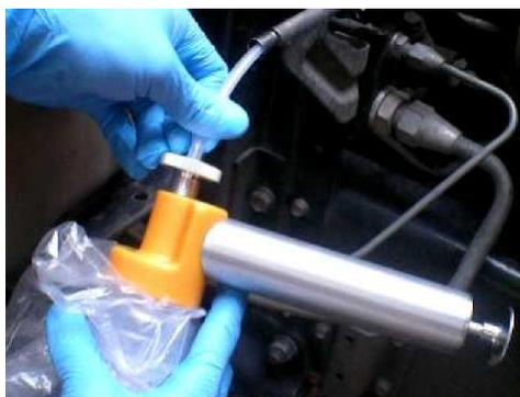
Figura 5. Botella con bolsa "ziplock" montada en la bomba de vacío manual.
