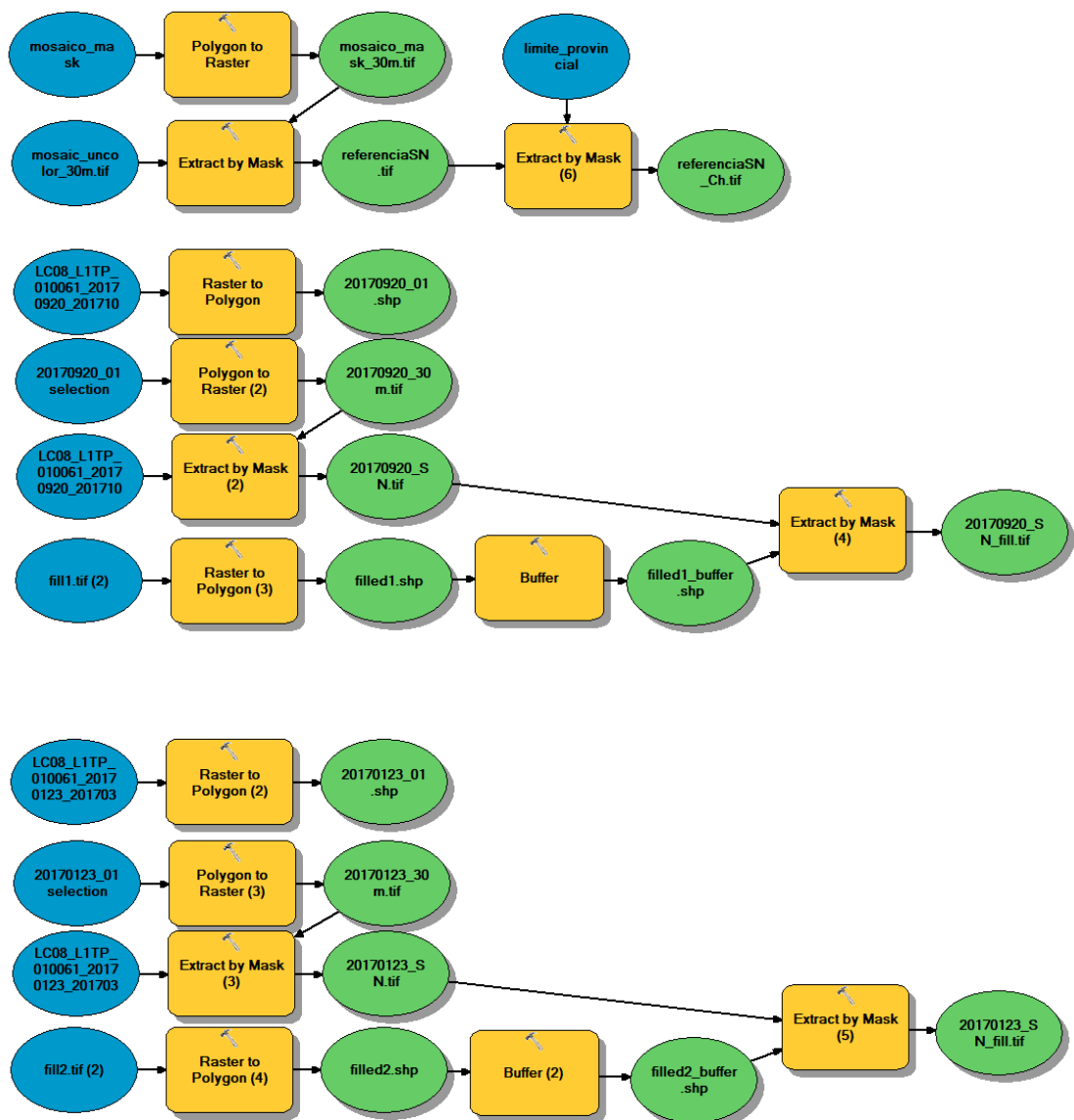
Figura 5. 10. Modelado cartográfico utilizado, en el mosaico de referencia y las imágenes de relleno. Aplicación ModelBuilder- ArcGis 10.2
