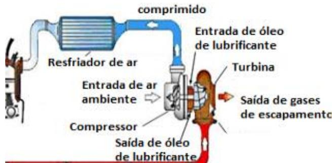
Figura 1. Funcionamento do resfriador de ar.
