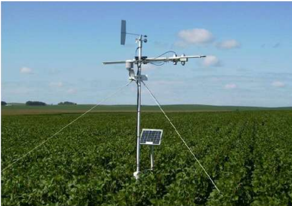
Figura 1. Estación de balance de energía instalada sobre un cultivo de Soja.
