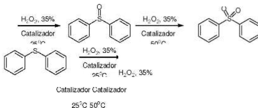
Esquema 1. Oxidación selectiva de difenilsulfuro en condiciones ecocompatibles.
