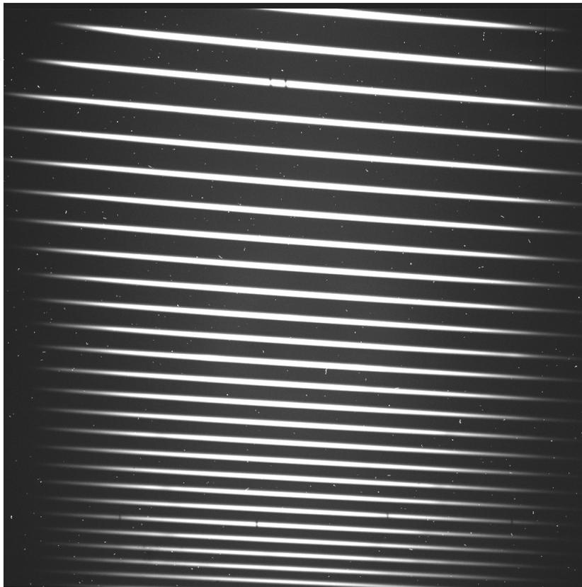
Figura 1.2: Imagen sin procesar de uno los espectros de CASLEO. La longitud de onda crece hacia la parte superior.
