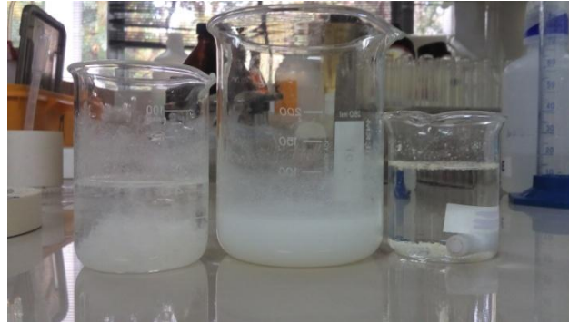
Figura 3: Precipitado que forma la flavanona al entrar en contacto con el agua.
