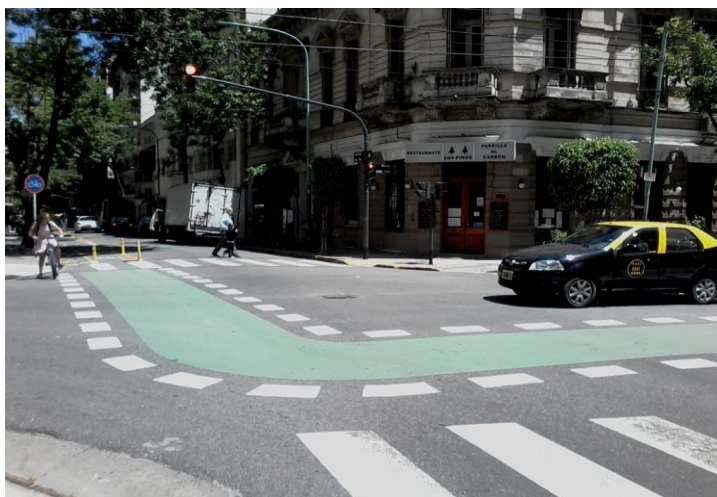
Foto 11. Bicisenda con claro diseño peligroso para el ciclista, por el giro brusco e inesperado que exige su trazada
