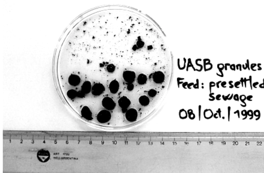
Figura 2. Gránulos observados en el reactor UASB (08/10/99).
