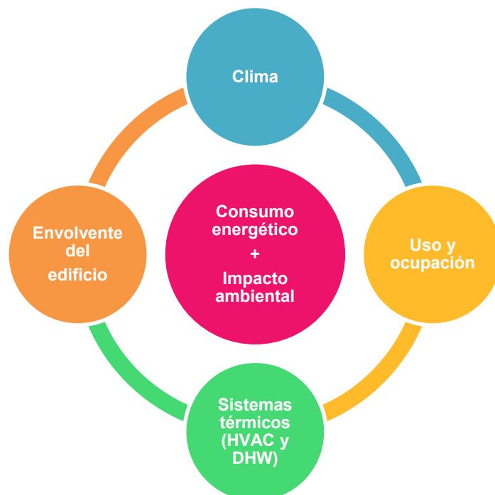
Figura 2: Relación entre las características del clima, de la envolvente, de uso y ocupación, y de las instalaciones en la determinación del consumo energético y del impacto ambiental de la edificación. Elaboración propia.
