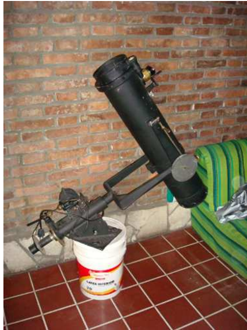
Figura 1. Mi telescopio reflector Newtoniano de 15 cm.
