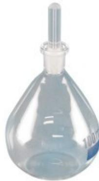
**Figura 2.3.** Fotografía de un picnómetro utilizado para calcular la densidad real de las muestras de suelo.
