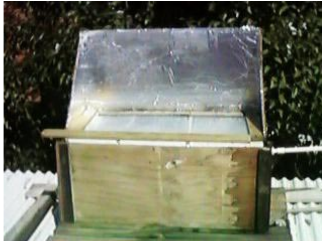
Figura 1 – La caja del colector solar apoyada en una base de madera sobre el tejado.
