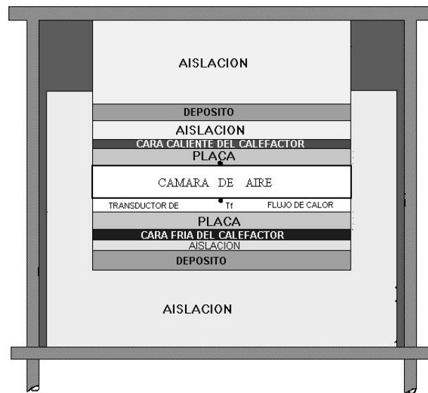
Figura 1: Esquema del aparato medidor del flujo de calor
