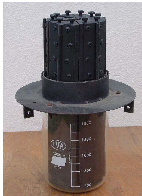
Figura 1.- Muestra el absorbedor con las barras de aluminio y la cubierta de pyrex.
