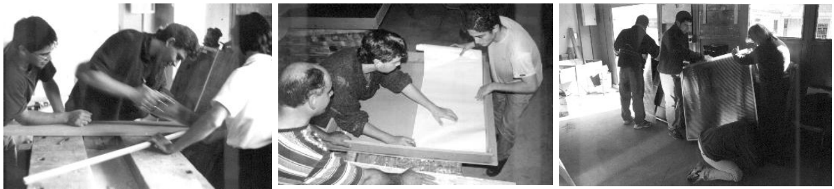
Figura 2: Construcción de los Módulos Captores.
