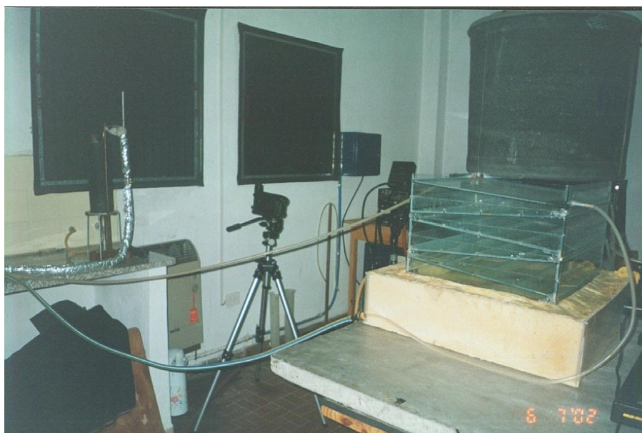
Figura 3. Disposición experimental para visualización de flujos en el destilador multietapa.
