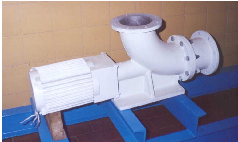
Foto 1 – Fotografía del conjunto turbina – generador terminado
