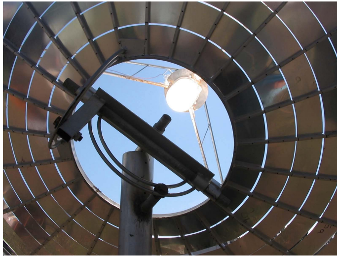
Figura 4: Vista de la parte posterior del absorbidor donde se observa los dos ejes de movimiento
