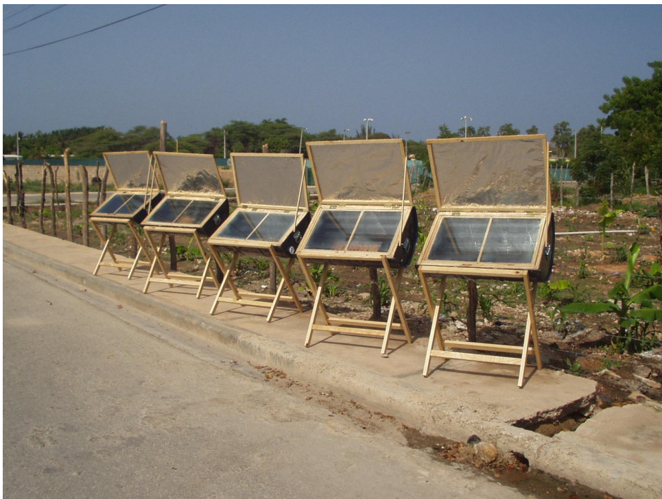
Figura 1.- Conjunto de 5 cocinas de tipo tanque construídas en un taller realizado en la República Dominicana
