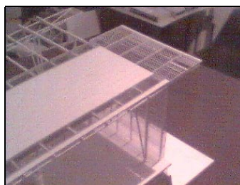
Fig. 3a. Invierno con entrada de sol Fig. 3b. Equinoccio, protección parcial Fig. 3c. Verano con protección total Figuras 3a., 3b., 3c. Ensayo estacional de incidencia solar en áreas de cubierta vidriada.
