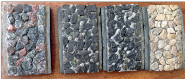
Figura 3: Probetas luego de ser pulimentadas. De izquierda a derecha: árido de referencia, basalto, gneiss, cuarcita.
