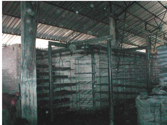
Figura 2. Detalles del túnel de secado: perchas, bandejas y entrada del túnel.
