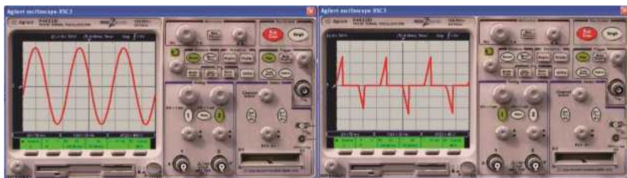
Figura 3: A mayor potencia activa (imagen de la izquierda) el motor utiliza el total de la onda sinusoidal de la tensión ( V_{rms} ) e intensidad de la corriente ( I_{rms} ). Pero en el motor síncrono (o sincrónico), cuando la onda sinusoidal es recortada por el disparo del Triac (imagen de la derecha); desciende el consumo de energía activa (kWh) por reducción de la potencia promedio o media activa ( P_{med} ) medida en vatios (Watts). Simulación del circuito conectado al osciloscopio Agilent XSC 3, del software NI Multisim 14.0. Elaboración propia.
